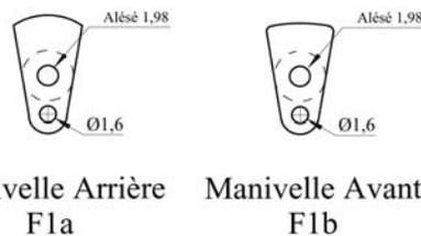
On utilisera le gabarit de perçage ci-dessous pour garantir que l'entraxe entre l'essieu et le maneton est identique pour toutes les pièces. Lors du perçage au diamètre de 1,6 mm, les manivelles seront centrées par un pion en stub de 2 mm.
