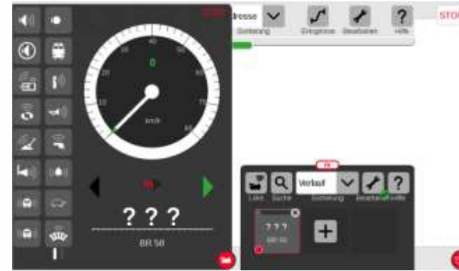
En glissant vers le milieu de l'écran, le pupitre de commande apparaît avec les symboles des fonctions et le tachimètre. La locomotive est prête à être conduite avec le régulateur de marche.
